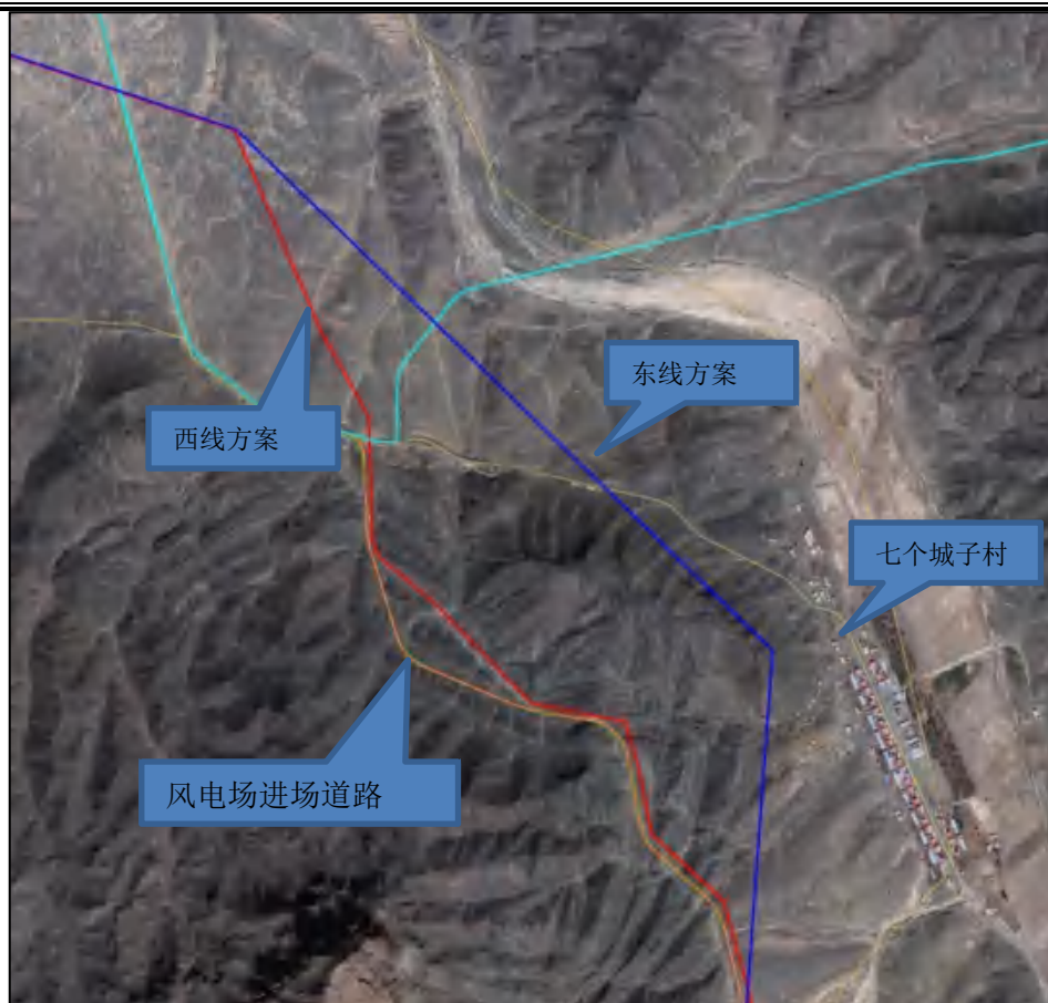
图 4.7-4 七个城子村段线路比选示意图
