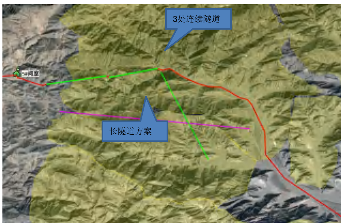
图 4.7-15 隧道方案穿越泥石流区示意图
