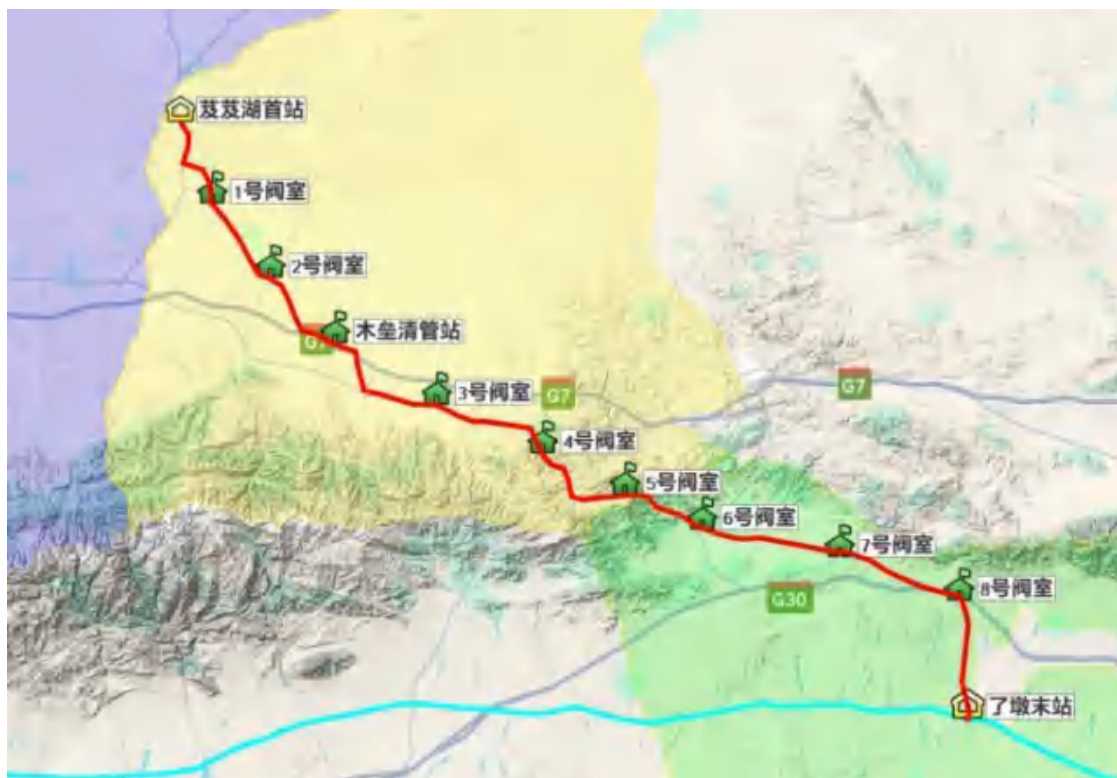
图1.4-1 线路管道走向及站场布置
