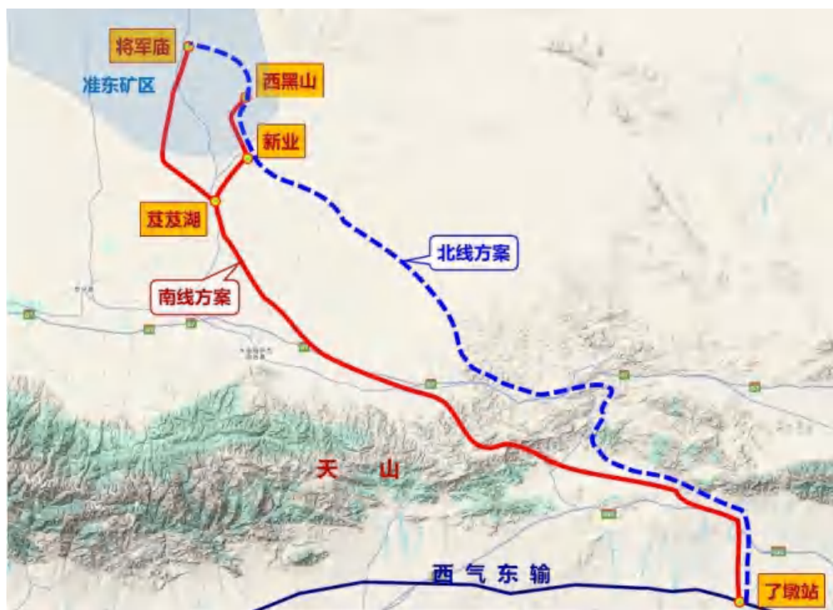
图 4.7-1 宏观路由比选方案走向示意图
