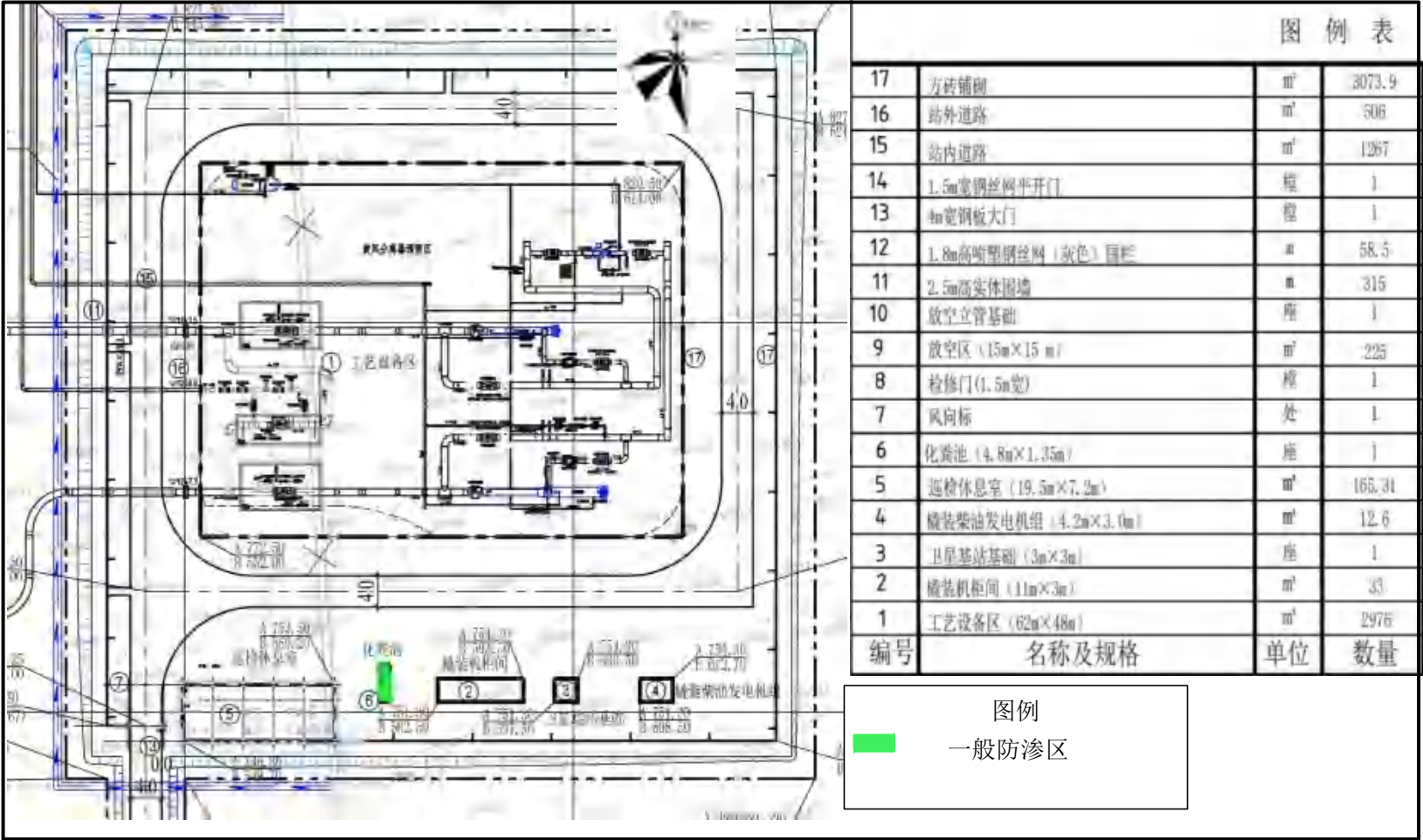
图8.3-2木垒清管站污染防渗分区示意图
