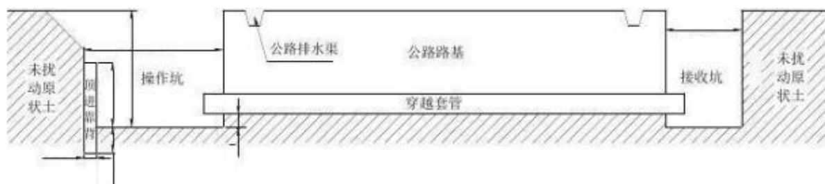
图 3.3-6 穿越道路施工作业示意图
