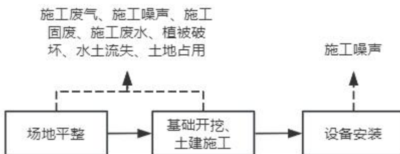
图 3.4.1-2 升压站施工工艺及产污环节
