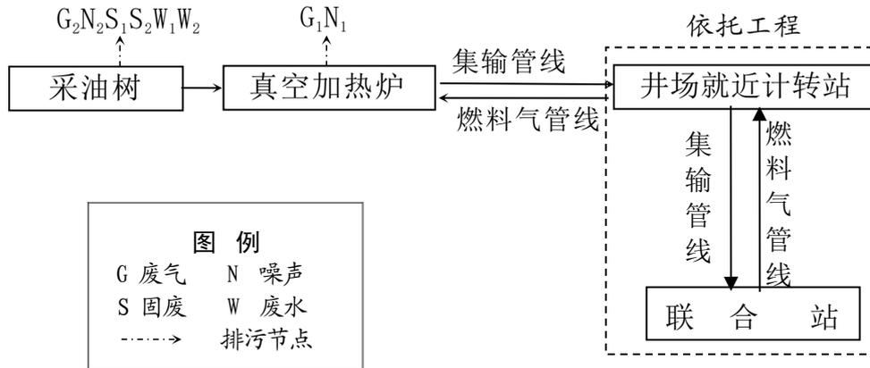
图 3.3-6 油气开采及集输工艺流程图
