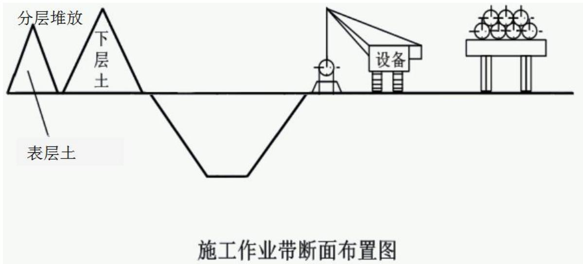
图 3.3-5 一般地段管道施工方式断面示意图
