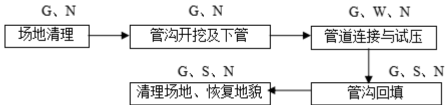
图 3.3-9 油气集输工程工艺流程及排污节点图
