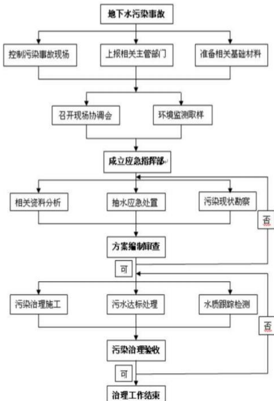
图 8.2.3-3 地下水污染应急治理程序图
