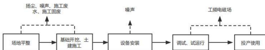
图 3.1.6-2 升压站施工工艺及产污环节
