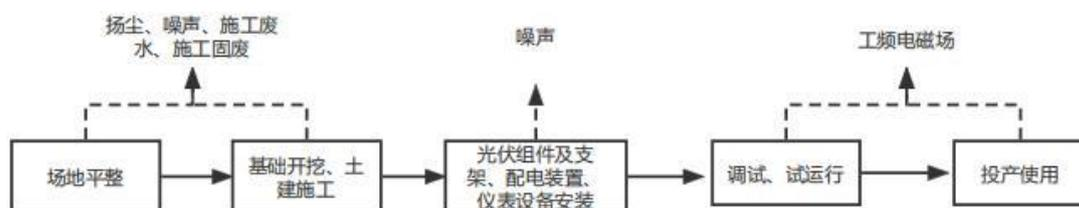
图 3.1.6-1 光伏区建设施工工艺及产污环节
